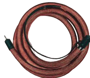
Min. bend radius = 12 x Nominal Ø
